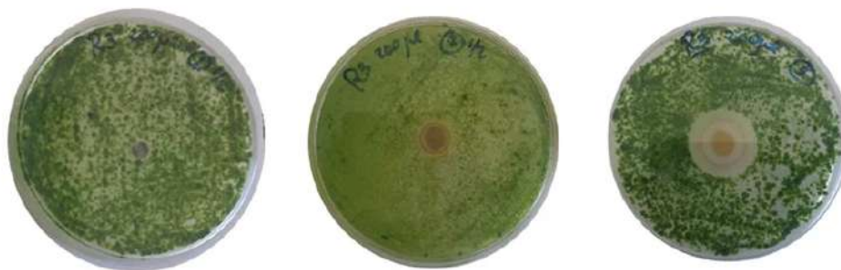
Figura 4. Resultados de ensayos de difusión en placa: a) actividad biocida nula, b) actividad biocida baja, c) actividad biocida alta.
